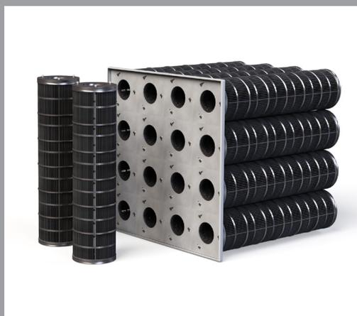
Le CamCarb Cylinder GlidePack de Camfil est un boîtier de filtre à accès latéral pour les cylindres adsorbants cylindriques recommandés pour les applications d'air d'appoint et de recirculation à forte charge de gaz/vapeur. Jusqu'à 96 livres de charbon imprégné par 2000 cfm de capacité du système et un joint d'étanchéité fournissent une capacité et une efficacité d'élimination plus élevées que les autres systèmes d'adsorption. Chaque CamCarb Cylinder GlidePack :
